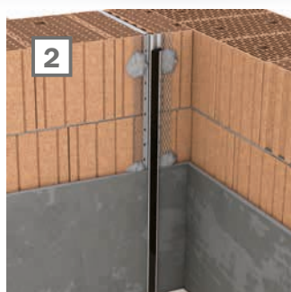
Dehnungsfuge Außenwand
