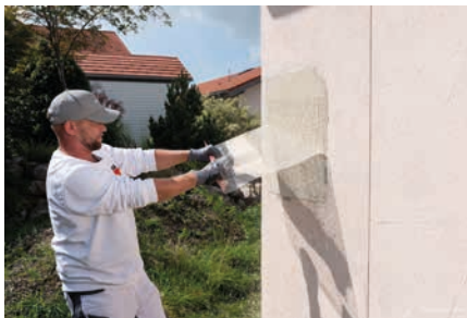
Für die Abrissprobe zur Voruntersuchung
