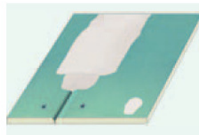
Die Qualitätsstufe 2/Q2 auch Standardverspachtelungen genannt – umfasst die Grundverspachtelung nach Q1 sowie das anschließende Nachspachteln der Fugenbereiche.
