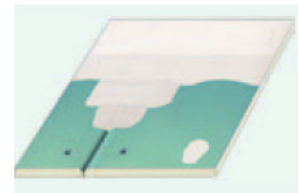
Die Qualitätsstufe 4/Q4 ist nur über ein anschließendes vollflächiges Spachteln oder Abstucken der Oberfläche zu erreichen.
