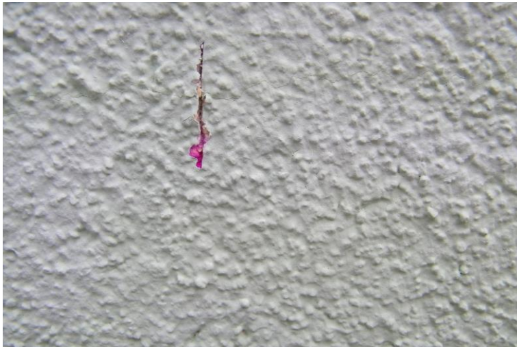
Ritzung und Beaufschlagung mit 1 % Phenolphthaleinlösung. Eine Alkalität in der Putzebene ist durch die Verfärbung erkennbar.
