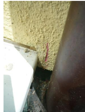
Ritzung und Beaufschlagung mit 1 % Phenolphthaleinlösung. Eine Alkalität in der Putzebene ist durch die Verfärbung erkennbar.
