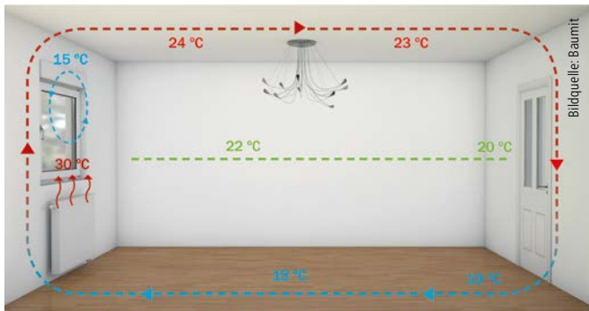
Abb. 2: Kalte Außenwände bewirken eine starke Konvektion und als Zugluft empfundene Zirkulation der Raumluft.
