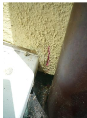
Ritzung und Beaufschlagung mit 1 % Phenolphthaleinlösung. Eine Alkalität in der Putzebene ist durch die Verfärbung erkennbar.
