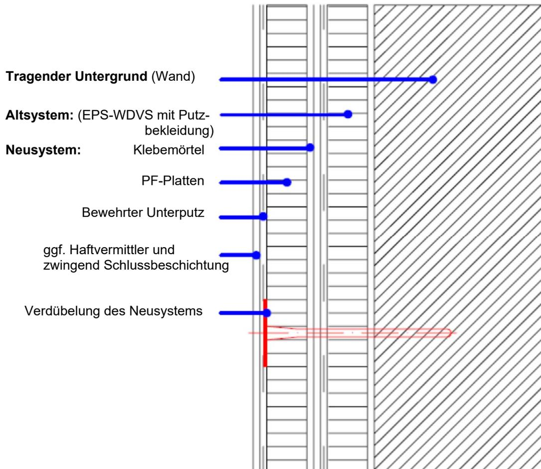
Aufbau des WDVS (Neusystem)
