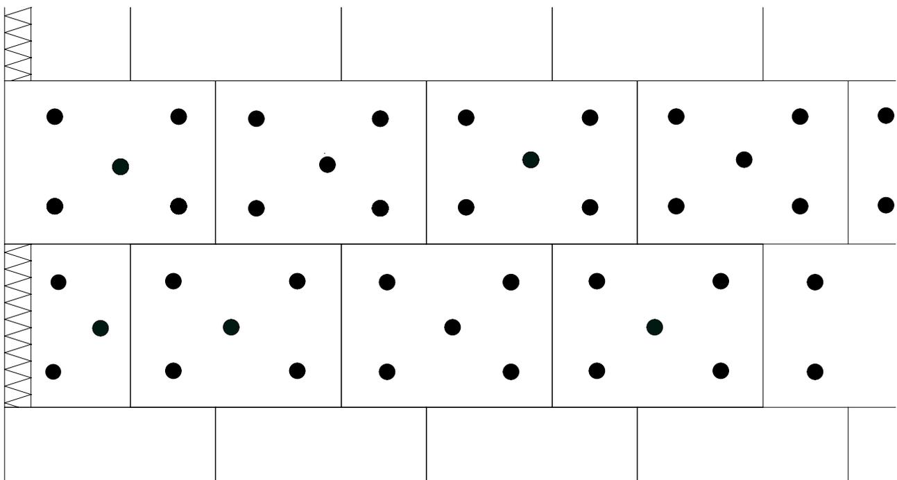
Mindestabstand Dübel zum Plattenrand beträgt 150 mm und zu den anderen Dübelschäften 200 mm
