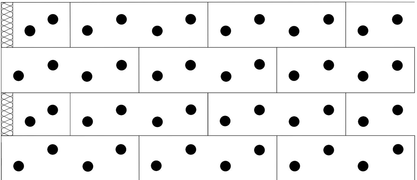
Mindestabstand Dübel zum Plattenrand beträgt 150 mm und zu den anderen Dübelschäften 200 mm
