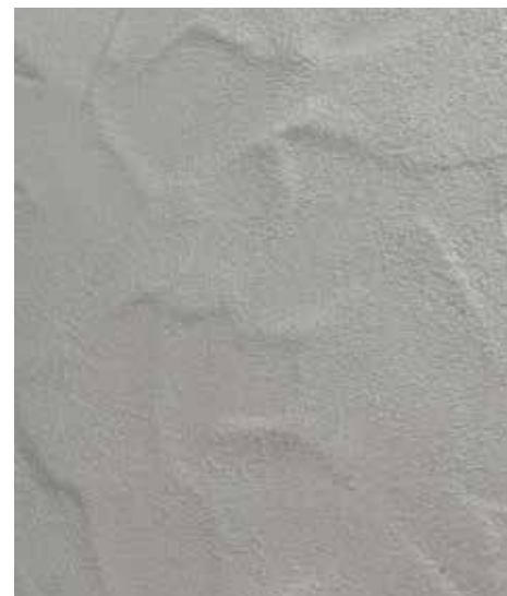
Die verwaschene Optik entsteht, indem etwas Mörtel dem Wasser beigegeben wird
