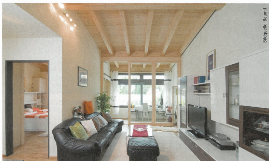
Abb. 9: Die Wohnungen, großzügig und barrierefrei geplant und realisiert. Aufgrund des hohen Holzanteils an Decke und Boden war ein Putzmaterial zur Wandbeschichtung gewünscht, welches eine sorptive Wirkung hat. Die Wahl fiel auf einen Lehmputz.
